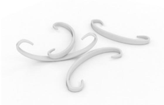
Зажимы в форме дуги с крючками на концах. Используются для стягивания склеенного шва трубной теплоизоляции из вспененного полиэтилена. Расход 3 шт на 1 п.м. теплоизоляции.
