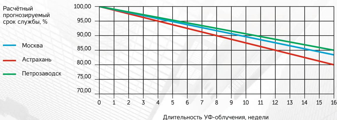
Для сохранения расчётного прогнозируемого срока службы рекомендуется в срок до 7 дней обеспечить защиту паро-гидроизоляции от воздействия прямого, рассеянного и отражённого УФ-излучения.
