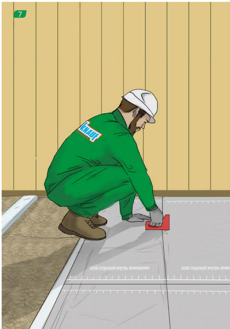
Поверх утепленного пола раскатываем пароизоляционную пленку - слева направо или справа налево. Каждый последующий слой укладываем с нахлестом 10-15 см. Фиксируем мембрану степлером. Стыки и места крепления степлером проклеиваем лентой для проклейки швов.
