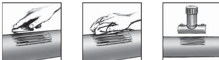
Рис. 4.2.15. Снятие оксидного слоя для установки седлового отвода
