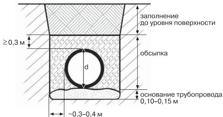
Рис. 4.1.2. Рекомендуемые параметры профиля траншеи
