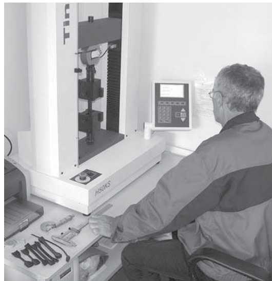
Фото 4.2.8. Испытания стыковых сварных соединений в лаборатории ИКАПЛАСТ
