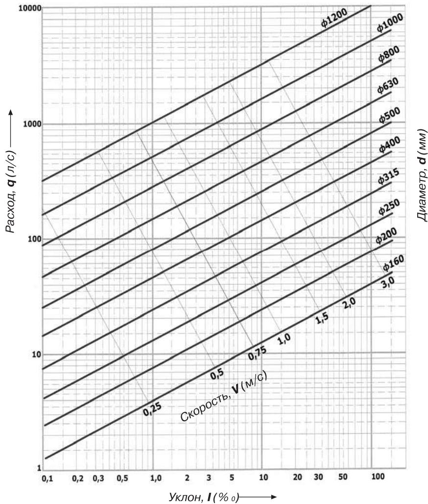
Рис. 2.2. Номограмма для определения диаметра самотечного трубопровода
