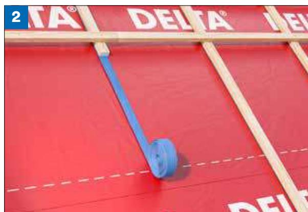
Все уплотнительные ленты DELTA® должны быть в достаточной степени прижаты к основанию с помощью контробрешётки. Поэтому следует соблюдать правила крепления контробрешётки: проектный шаг крепления (не более 33 см) и верно подобранный крепёж необходимого диаметра и длины с неполной резьбой. Неровная поверхность контробрешётки, стропил и сплошного настила может снизить надёжность уплотнения.
