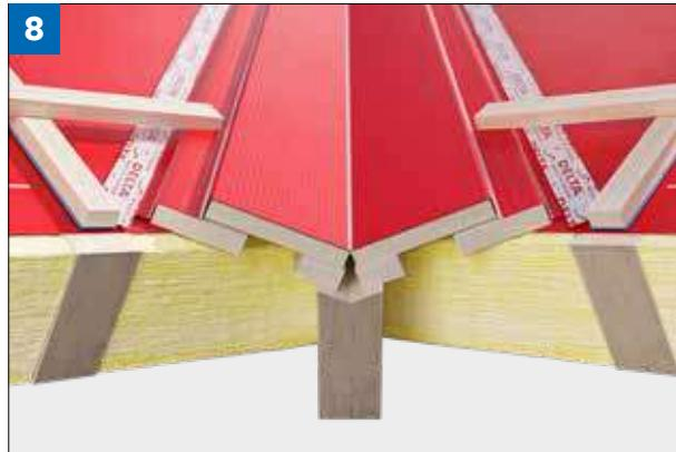
**(Рис. 8)** Предпочтительной конструкцией ендовы является сплошное основание из досок, которое будет надёжной опорой для желобка ендовы и шаговой обрешётки, примыкающей к ендове. Диффузионную плёнку уложить поверх сплошного настила ендовы от карниза до конька, после присоединить полотна со стороны прилегающих скатов при помощи клея DELTA®-THAN или ленты DELTA®-MULTI-BAND. Нахлест вдоль ендовы следует выполнить не менее 150 мм.
