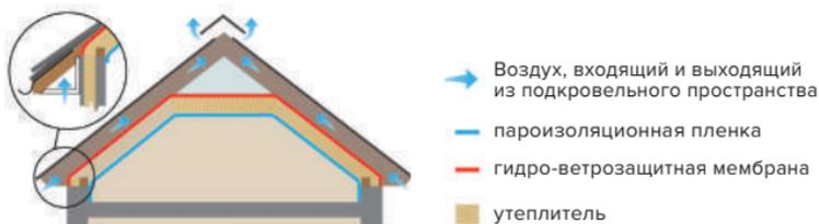
Рис. 3.1. Устройство вентиляции мансарды
