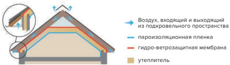
Рис. 3.1. Устройство вентиляции мансарды
