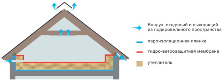
Рис. 3.9. Устройство вентиляции холодного чердака
