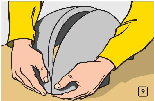
После подсыхания клея, прижмите две полусекции друг к другу сначала с одного, а затем с другого конца. Продолжите склейку шва двигаясь от краев к середине (рис. 9).
