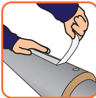
Проклейте швы самоклеющейся алюминиевой лентой ЛАС-П таким образом, чтобы лента закрывала заклепки и нижний слой на 10-15 мм.
