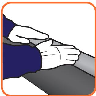
Уложите материал на поверхность теплоизоляционного слоя.
