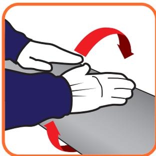
Оберните материал вокруг изолированного трубопровода с нахлестом 3-5 см.
