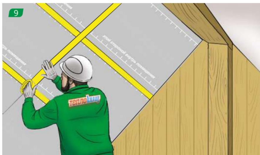
Стыки и места крепления степлером проклеиваем лентой для проклейки швов.
