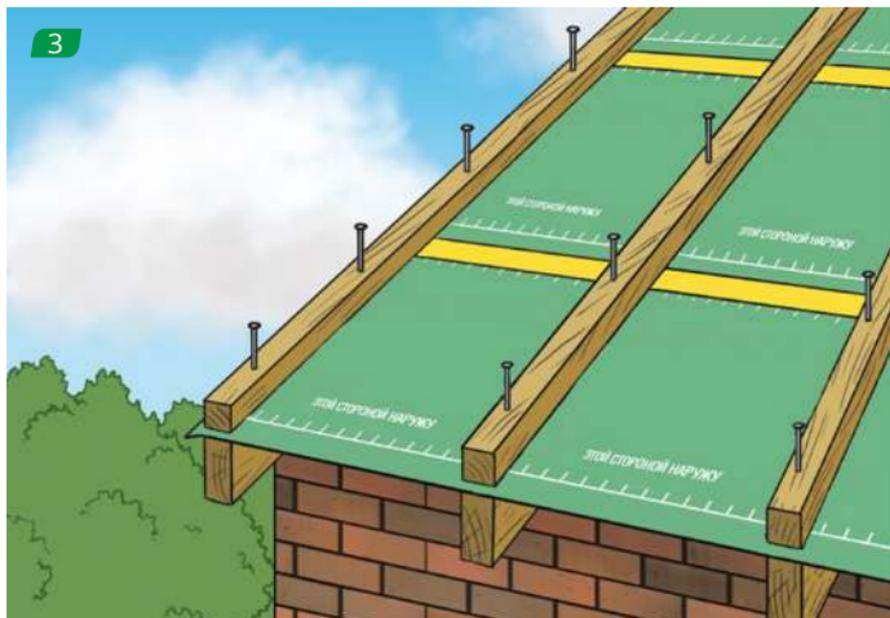
Устанавливаем поверх мембраны прижимной брусок и фиксируем его к стропилам.
