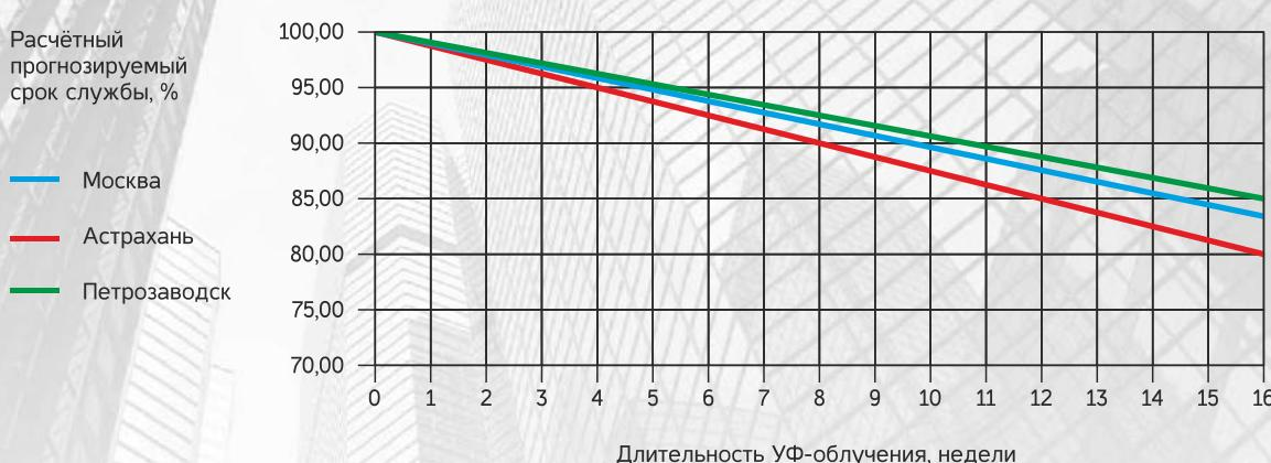
Для сохранения расчётного прогнозируемого срока службы рекомендуется в срок до 7 дней обеспечить защиту гидро-ветрозащитной мембраны от воздействия прямого УФ-излучения, посредством монтажа внешней облицовки (полного комплекта кровельного/фасадного покрытия), а также защиту от воздействия рассеянного или отражённого УФ-излучения (например, через окна мансардного этажа), посредством монтажа внутренней отделки.
