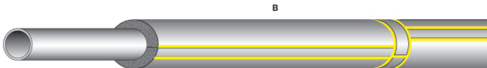
B) При наружном применении, если это необходимо, проклейте края самоклеящейся ленты морской герметиком.
