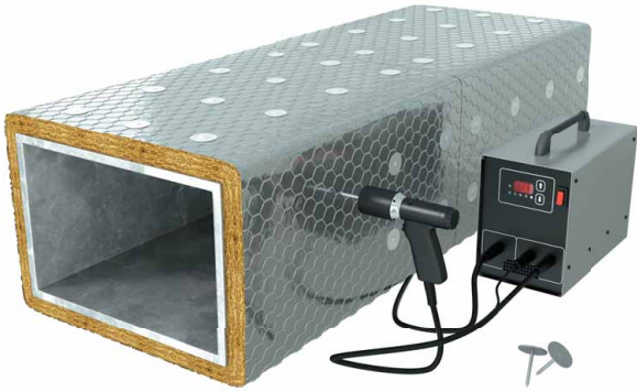
Рисунок 1. Крепление с помощью штифтов типа CD/PWP2,7 с расходом 9 штук на м 2
