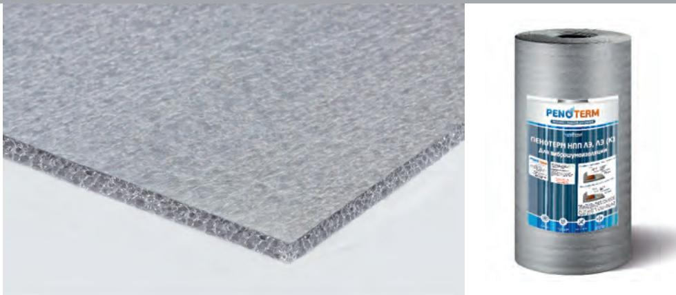
Пенотерм НПП ЛЭ – виброшумоизоляционный рулонный материал. Он изготовлен экструзионным методом из вспененного полипропилена с добавлением вспенивателя, антиприренов, пластифицирующих и стабилизирующих добавок. Материал используется в качестве вибродемпфирующей прокладки в конструкциях «плавающих полов» для улучшения изоляции ударного и воздушного шума.
