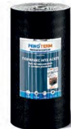
Порилекс НПЭ ЛСКП – рулонный укрывной теплоизоляционный материал для бетонирования в условиях низких температур. Он изготовлен из вспененного полиэтилена толщиной 10 мм, дублированного с черной полиэтиленовой пленкой 150 мкм для увеличения износостойкости материала.
