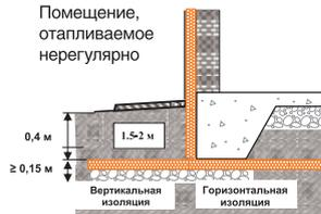
В вырытый котлован глубиной 50-60 см засыпают песчано-гравийную смесь толщиной 15 см. 04. На выровненную площадку укладываются плиты ПЕНОПЛЭКС® (толщина плит 40-100 мм – зависит от климатических условий и от грунта) 05. Далее производится заливка фундамента. В случае строительства отапливаемого здания на фундамент вертикально укладываются плиты ПЕНОПЛЭКС® 06. Производится обратная засыпка грунта 07.
