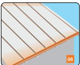
Уложенные плиты **ПЕНОПЛЭКС®** крепятся верхними продольными рейками **06**. Высота реек должна быть не менее 40 мм, что является необходимым условием нормальной вентиляции кровли над плитами **ПЕНОПЛЭКС®**. Перед креплением рейки в ней просверливают отверстия для предотвращения появления трещин. Рейки крепятся гвоздями или саморезами, шаг 30 см.
