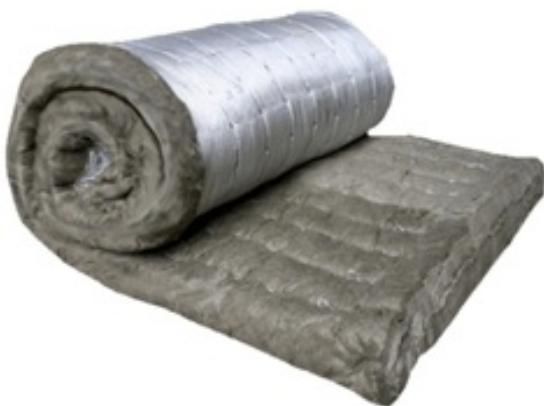
Теплоизоляционный прошивной базальтовый мат без связующего со стеклосеткой с 1 стороны. Используется для теплоизоляции инженерных систем, промышленного оборудования на нефтегазовых объектах, АЭС, ТЭЦ, ГРЭС.
