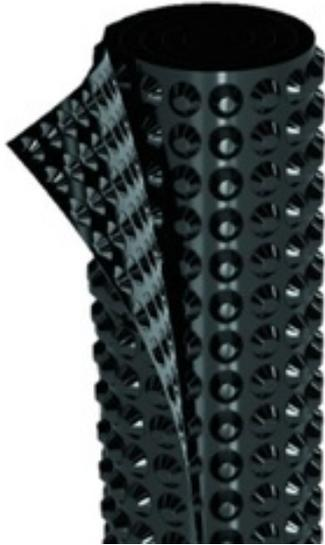
Полотно из полиэтилена высокой плотности с отформованными круглыми выступами 8,5 мм. Используется для защиты и гидроизоляции фундамента от повреждений при обратной засыпке на вертикальных и горизонтальных поверхностях.
