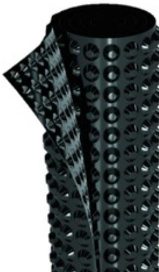
Полотно из полиэтилена высокой плотности с отформованными круглыми выступами 8,5 мм. Используется для защиты и гидроизоляции фундамента от повреждений при обратной засыпке на вертикальных и горизонтальных поверхностях.
