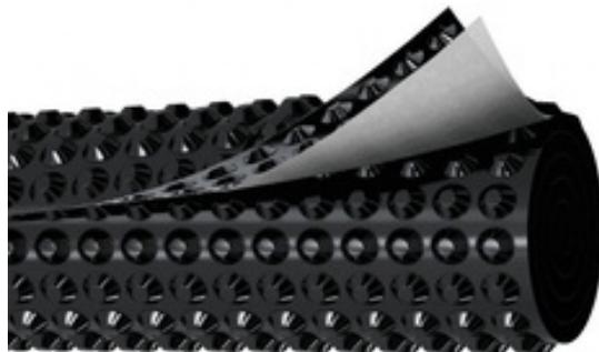
Полотно из полиэтилена высокой плотности с отформованными круглыми выступами высотой 7,5 мм. Используется для защиты гидроизоляционного слоя фундаментов и фундаментальной плиты от капиллярной влаги в коттеджном и малоэтажном строительстве.
