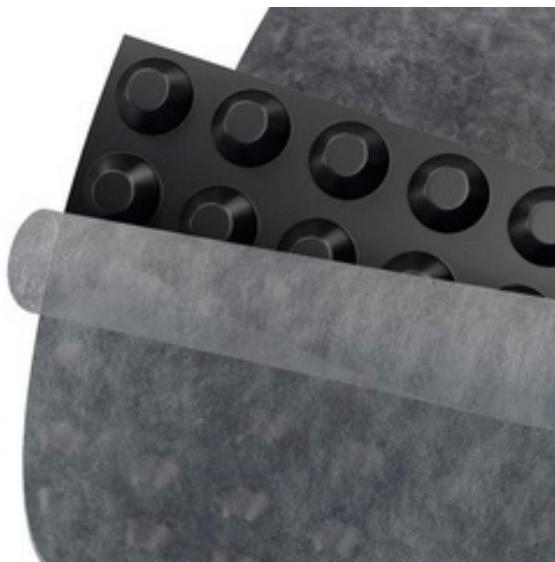
Двухслойное полотно из ПВП профилированной мембраны и термоскреплённого геотекстиля. Высота шипов 8 мм. Используется для защиты гидроизоляционного слоя и организации пристенного дренажа.
