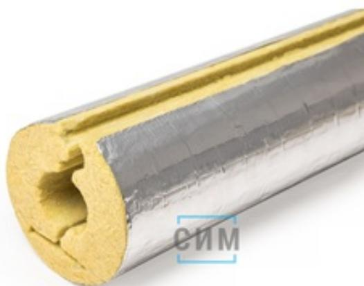
Негорючие теплоизоляционные цилиндры из каменной ваты с продольным разрезом «выступ-впадина». Покрытие – плотная алюминиевая фольга без стеклосетки. Особенно востребованы на объектах с повышенным требованием к пожарной безопасности.
