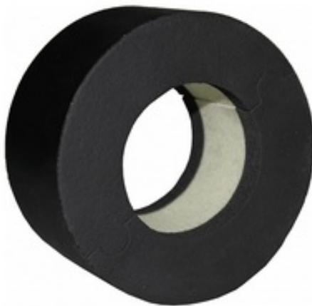
Теплоизоляционный подвес из двух полуцилиндров пенополиуретана высокой плотности с боковым покрытием из эластомерного каучука и паронепроницаемой оболочкой. Без металлического хомута.
