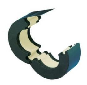
Теплоизоляционный подвес из двух полуцилиндров пенополиуретана высокой плотности с боковым покрытием из эластомерного каучука и паронепроницаемой оболочкой. Без металлического хомута.
