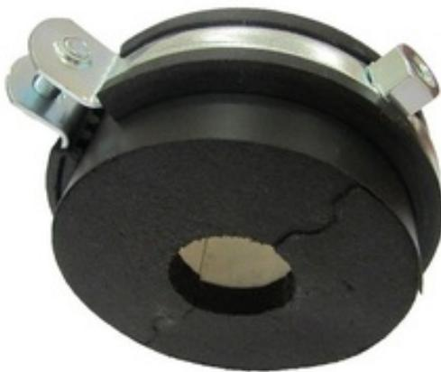
Теплоизоляционный подвес из двух полуцилиндров пенополиуретана высокой плотности с боковым покрытием из эластомерного каучука и паронепроницаемой оболочкой. С металлическим хомутом.
