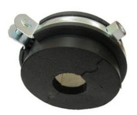
Теплоизоляционный подвес из двух полуцилиндров пенополиуретана высокой плотности с боковым покрытием из эластомерного каучука и паронепроницаемой оболочкой. С металлическим хомутом.
