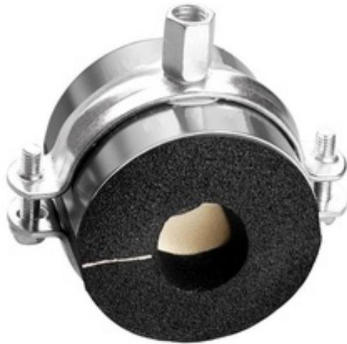
Теплоизоляционный подвес из двух полуцилиндров пенополиуретана высокой плотности с боковым покрытием из эластомерного каучука и металлизированной паронепроницаемой оболочкой. Без металлического хомута.
