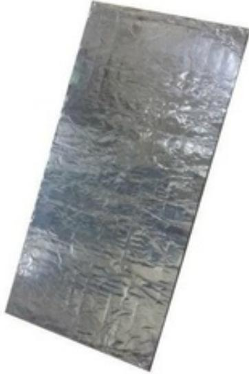
Теплоизоляционный картон из базальтовой ваты с покрытием алюминиевой фольгой. Используется для утепления резервуаров, промышленного оборудования, бани и сауны. ТУ 95.2691-98.
