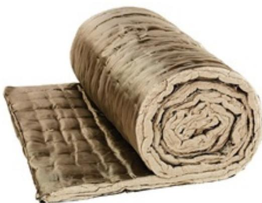
Теплоизоляционный прошивной базальтовый мат без связующего. В обкладке базальтовой тканью ТБК-100 с 2х сторон. Используются для теплоизоляции инженерных систем, промышленного оборудования на нефтегазовых объектах, АЭС, ТЭЦ, ГРЭС.
