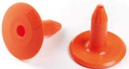
Дюбель из полимерного материала с тарельчатой шляпкой. Применяется для крепежа теплоизоляции к несущему основанию кровли. Используется вместе с кровельным саморезом.
