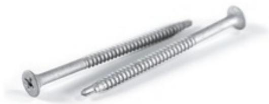
Кровельный сверлоконечный саморез (шуруп) РОКС FBD из высококачественной закаленной углеродистой стали SAE 1022 с антикоррозионными покрытиями. Применяется при креплении в профилированный металлический лист толщиной 1–3 мм.
