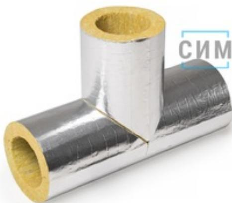
Теплоизоляционный тройник из каменной ваты с покрытием фольма-тканью. Легко и быстро монтируется. Специалисты используют теплоизоляцию на улице вместо оцинкованных тройников. Клеевой нахлёт не предусмотрен.
