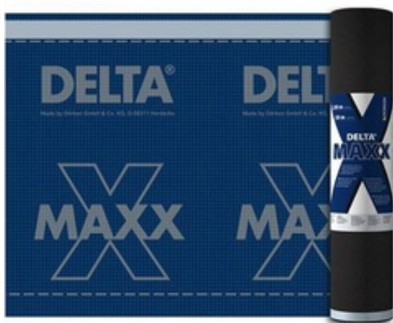
Прочный нетканый материал с внешним слоем из термопластичного полиуретана и адсорбционным слоем. С двух сторон рулона клейкая лента. Паропроницаемая воздухонепроницаемая мембрана применяется скатной кровле и вентилируемом фасаде.
