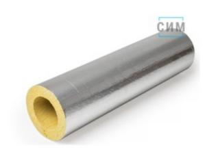
Теплоизоляционные цилиндры из каменной ваты с продольным разрезом «выступвпадина». Покрытие — алюминиевая фольга, армированная стеклосеткой. Востребованы для трубопроводов в помещении и в каналах.
