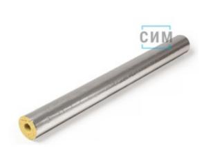
Теплоизоляционные цилиндры из каменной ваты с продольным разрезом «выступвпадина». Покрытие — фольма-ткань с продольным клеевым нахлёстом. Популярны в качестве альтернативы оцинкованному покрытию, монтируют в помещении.
