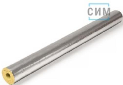
Теплоизоляционные цилиндры из каменной ваты с продольным разрезом «выступ-впадина». Покрытие – фольма-ткань с продольным kleевым нахлестом.
