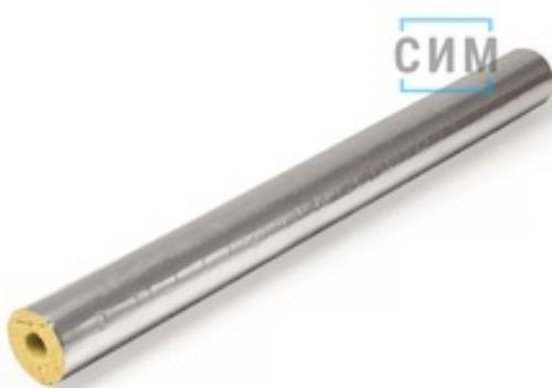
Теплоизоляционные цилиндры из каменной ваты с продольным разрезом «выступ-впадина». Покрытие – фольма-ткань с продольным и поперечным нахлестом для монтажа герметиком. Популярны в качестве альтернативы оцинкованному покрытию, монтируют на улице.
