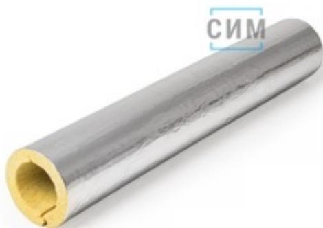
Негорючие теплоизоляционные цилиндры из каменной ваты с продольным разрезом «выступ-впадина». Покрытие – плотная алюминиевая фольга без стеклосетки. Особенно востребованы на объектах с повышенным требованием к пожарной безопасности.
