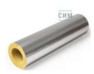
Теплоизоляционные цилиндры из каменной ваты с продольным разрезом «выступвпадина». Покрытие — фольма-ткань с продольным и поперечным нахлёстом для монтажа герметиком. Популярны в качестве альтернативы оцинкованному покрытию, монтируют на улице.
