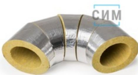
Теплоизоляционный отвод 90° из каменной ваты с покрытием фольма-тканью с kleевым нахлестом и герметиком в комплекте. Легко и быстро монтируется. Специалисты используют теплоизоляцию на улице вместо оцинкованных колен и поворотов.
