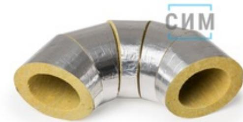
Теплоизоляционный отвод 90° из каменной ваты с покрытием фольма-тканью с клеевым нахлестом и герметиком в комплекте. Легко и быстро монтируется. Специалисты используют теплоизоляцию на улице вместо оцинкованных колен и поворотов.
