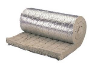
Прошивные теплоизоляционные маты из минеральной ваты со стальной оцинкованной сеткой. Покрыт с одной стороны алюминиевой армированной фольгой. Применяются для тепловой изоляции резервуаров, оборудования и трубопроводов.
