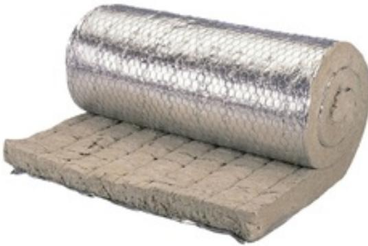
Прошивные теплоизоляционные маты из минеральной ваты со стальной оцинкованной сеткой. Покрывает с одной стороны алюминиевой армированной фольгой. Применяются для тепловой изоляции резервуаров, оборудования и трубопроводов.
