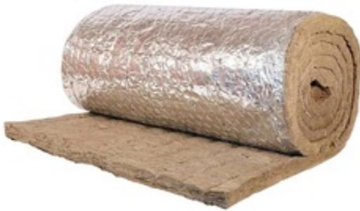
Прошивные теплоизоляционные маты из минеральной ваты со стальной оцинкованной сеткой. Покрывает с одной стороны алюминиевой фольгой. Применяются для тепловой изоляции резервуаров, оборудования и трубопроводов.
