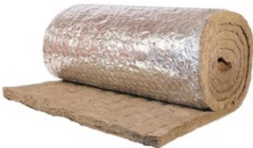
Прошивные теплоизоляционные маты из минеральной ваты со стальной оцинкованной сеткой. Покрыт с одной стороны алюминиевой фольгой. Применяются для тепловой изоляции резервуаров, оборудования и трубопроводов.
