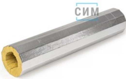
Теплоизоляционный цилиндр из ламелей, закреплённых на армированную алюминиевую фольгу. Покрытие с клеевым нахлестом. Профессионалы монтируют цилиндры в помещении на трубопроводы систем отопления и водоснабжения.
