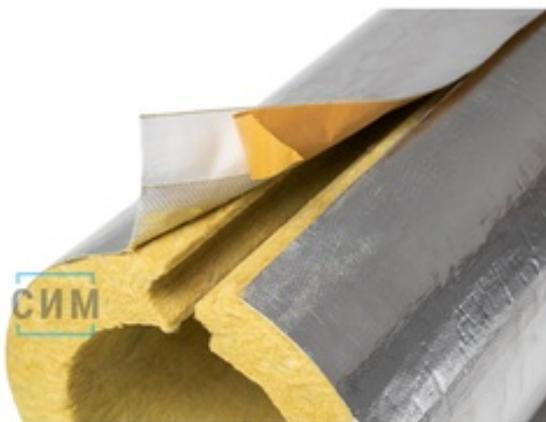
Теплоизоляционный цилиндр из ламелей, закреплённых на фольма-ткань. Покрытие с клеевым нахлёстом. Профессионалы монтируют цилиндры в помещении на трубопроводы систем отопления и водоснабжения.
