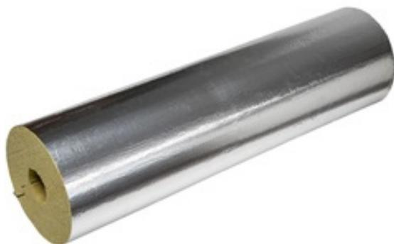
Теплоизоляционные вырезные цилиндры из каменной ваты с отражающим покрытием. Изготавливаются с самофиксирующимся замком. Применяются для технологических трубопроводов, паропроводов, тепловых сетей, ИТП, систем отопления и водоснабжения.
