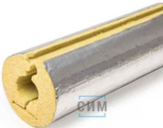
Негорючие теплоизоляционные вырезные цилиндры из каменной ваты с отражающим покрытием. Изготавливаются с самофиксирующимся замком. Применяются для технологических трубопроводов, паропроводов, тепловых сетей, ИТП, систем отопления и водоснабжения.
