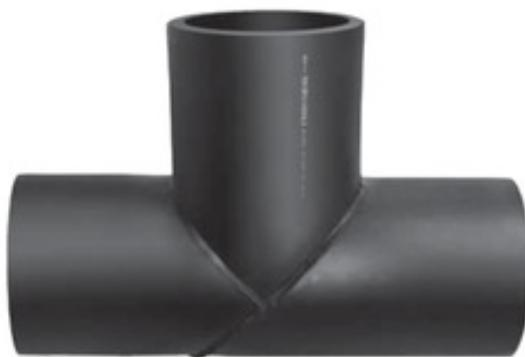
Фитинг из полиэтилена ПЭ 100 RC с тремя проходами одинакового диаметра. Угол 90°. Применяется для напорных сетей водоснабжения и водоотведения.
