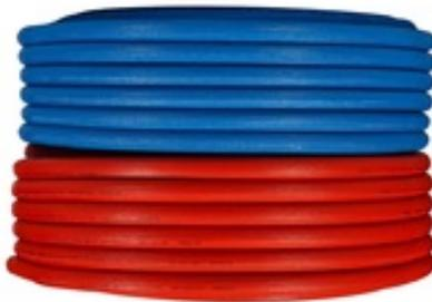
Многослойная труба на основе полиэтилена PE-RT тип II со слоем алюминия в теплоизоляции. Выпускается в синем и красном цвете для быстрого визуального отличия ХВС и ГВС. Используется в системе отопления, тёплого пола, ХВС и ГВС.
