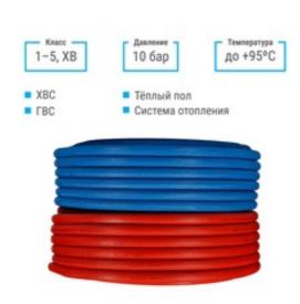
Многослойная труба на основе полиэтилена PE-RT тип II в теплоизоляции. Выпускается в синем и красном цвете для быстрого визуального отличия ХВС и ГВС. Используется в системе отопления, тёплого пола, ХВС и ГВС.
