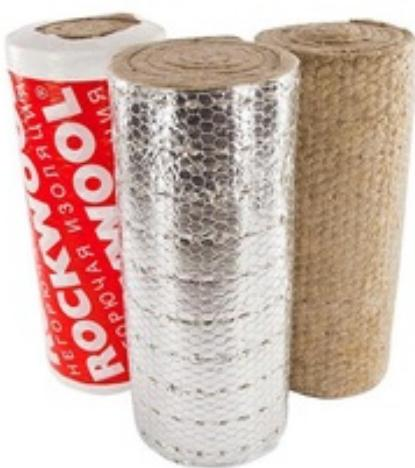
Базальтовый мат с неармированной алюминиевой фольгой. Прошит сеткой из гальванизированной проволоки. Используются для огнезащиты вентиляций и воздуховодов. Промышленные предприятия теплоизолируют оборудование, большие трубопроводы, резервуары, ёмкости.
