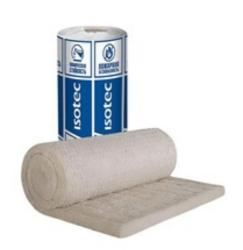
Прошивные теплоизоляционные огнезащитные маты из минеральной ваты со стальной оцинкованной или нержавеющей сеткой. Применяются для тепловой изоляции и огнезащиты резервуаров, трубопроводов и промышленного оборудования.
