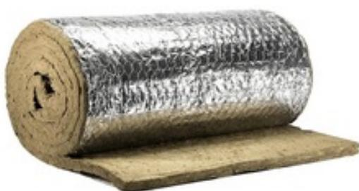
Прошивные теплоизоляционные огнезащитные маты из минеральной ваты со стальной оцинкованной сеткой. Покрыт с одной стороны алюминиевой фольгой. Применяются для тепловой изоляции и огнезащиты резервуаров, оборудования и трубопроводов.
